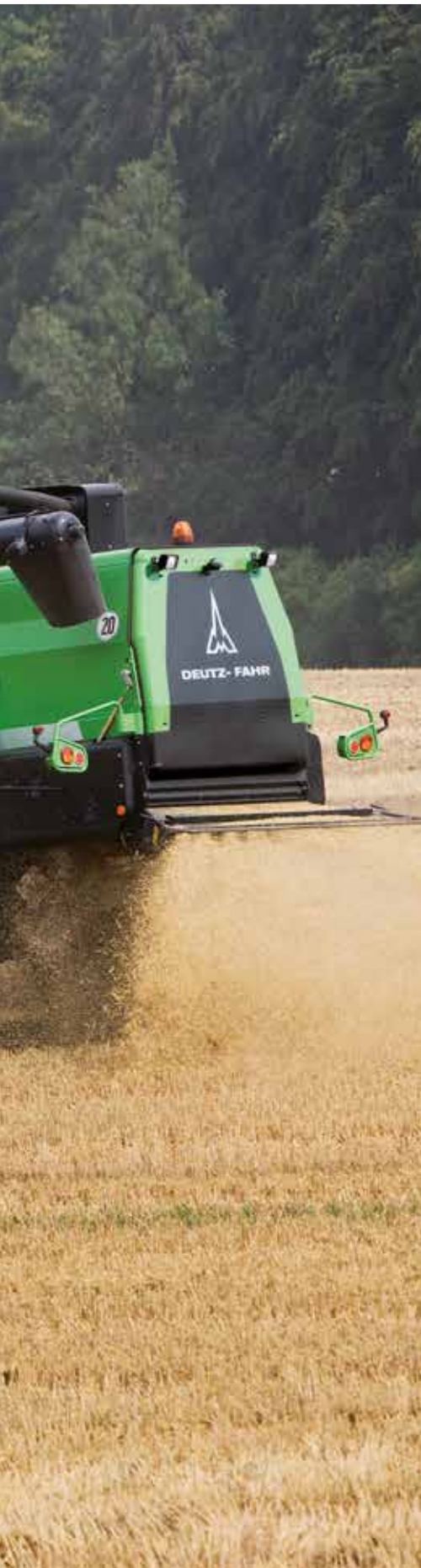
Mit Balance werden Längs- und Seitenneigungen des Schneidwerks von 6 und 20 % automatisch und feinfühlig ausgeglichen. Beste Voraussetzungen für eine saubere und produktive Ernte.
