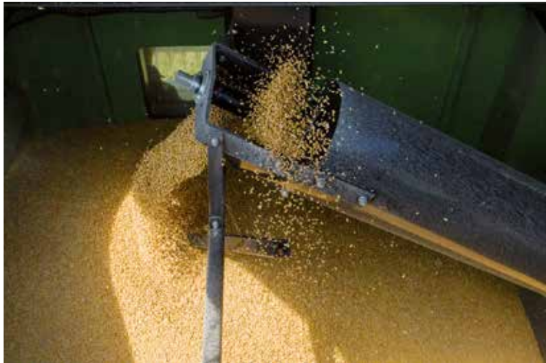
Der klappbare Körnerelevator sorgt für eine besonders schonende Kornbehandlung.
