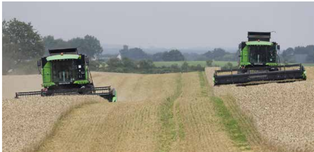
Mit Balance werden Längs- und Seitenneigungen des Schneidwerks von 6 und 20 % automatisch und feinfühlig ausgeglichen. Beste Voraussetzungen für eine saubere und produktive Ernte.
