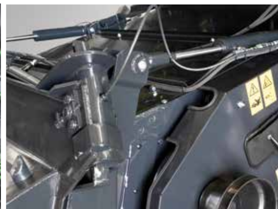
Die elektrohydraulische Schnittwinkelverstellung ermöglicht eine optimale Anpassung des Schneidwerks an die Bodenkonturen.
