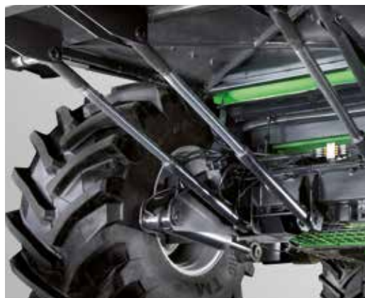
Die robusten, auf 25 Tonnen ausgelegten Untersetzungsgetriebe ermöglichen Einsätze unter schwierigsten Bedingungen und garantieren dabei nicht nur höchste Zuverlässigkeit, sondern vor allem eine beruhigende Fahrsicherheit.
