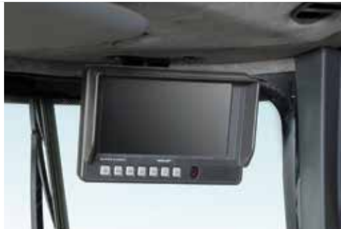
7-Zoll 4-Kanal Monitor zur Anzeige der Bilder der IR-Farbkameras.
