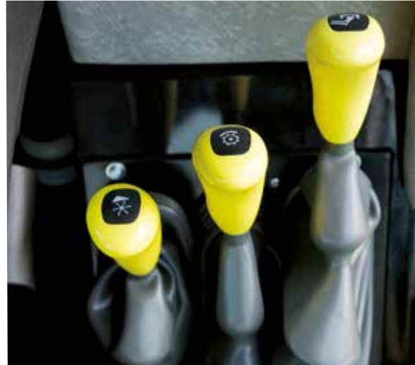
Die Schalthebel sind so auf der linken Seite angeordnet, dass sie den Zugang zum Fahrersitz nicht behindern.
