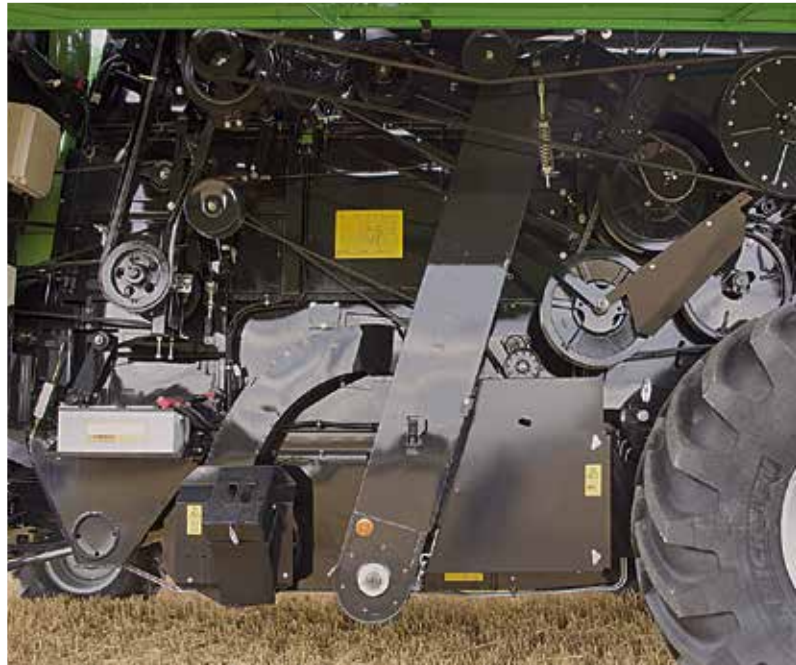
Die beidseitige Überkehrrückführung vermeidet Überlastungen des Dreschsystems zugunsten höherer Produktivität.
