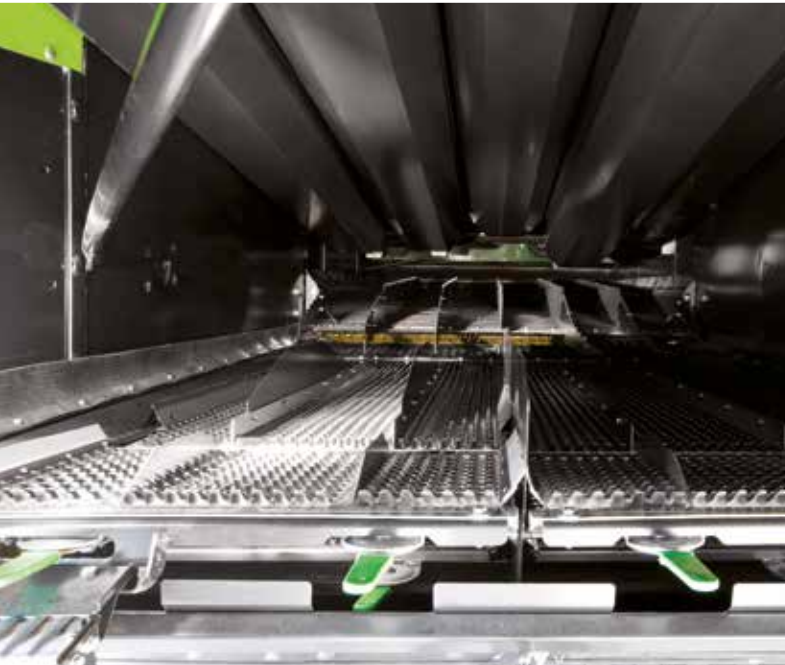
Die großflächigen Siebe garantieren herausragende Reinigungsleistungen. Mit dem Querstromgebläse und den zwei Fallstufen setzt der neue 6040 Maßstäbe in dieser Leistungsklasse.
