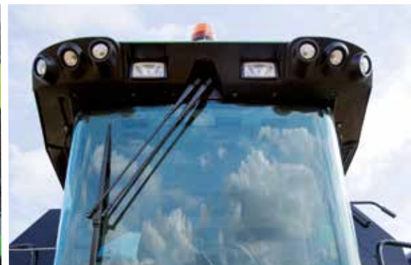
Die Arbeitsscheinwerfer auf dem Kabinendach leuchten den Arbeitsbereich optimal aus und erleichtern damit die Nachternte erheblich.
