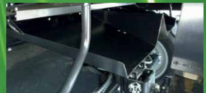
Neuer Spreuverteiler mit Zuführblech für gleichmäßige Verteilung.
