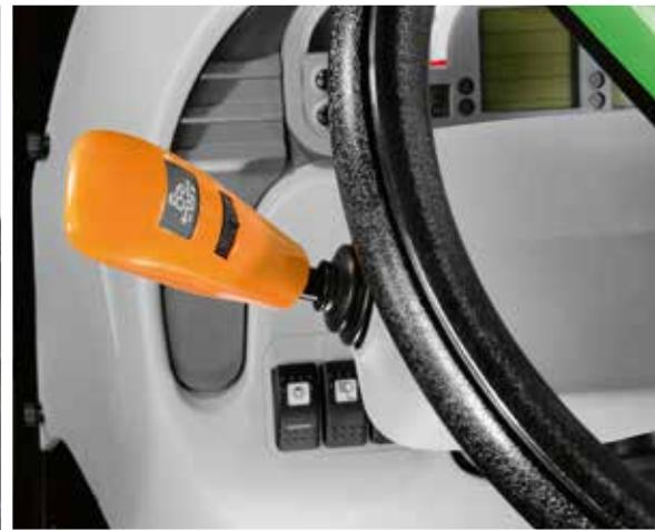
Der hydraulische Powershuttle ist in fünf Stufen einstellbar und erleichtert die Rangierarbeiten erheblich.
