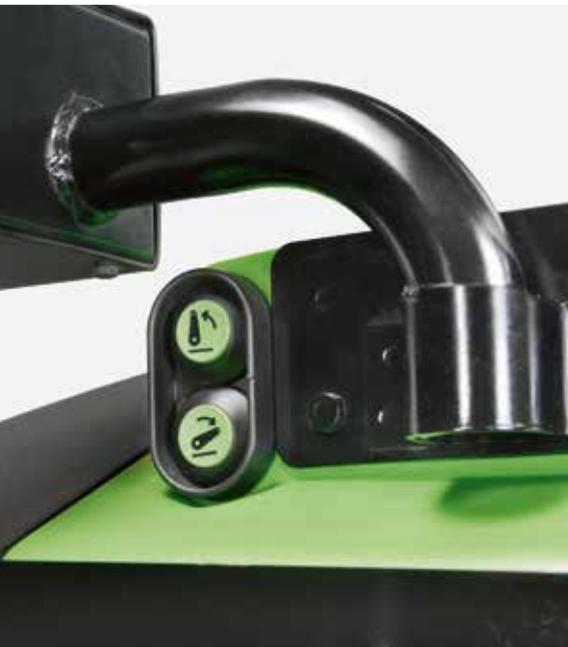
Betätigung des elektronischen Krafthebers über Bedienelemente an beiden Heckkotflügeln
