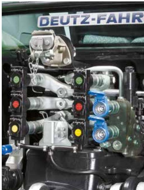
Gut zu erreichen und übersichtlich: die Hydraulikanschlüsse. Auf Wunsch bis zu vier Zusatzsteuergeräte.
