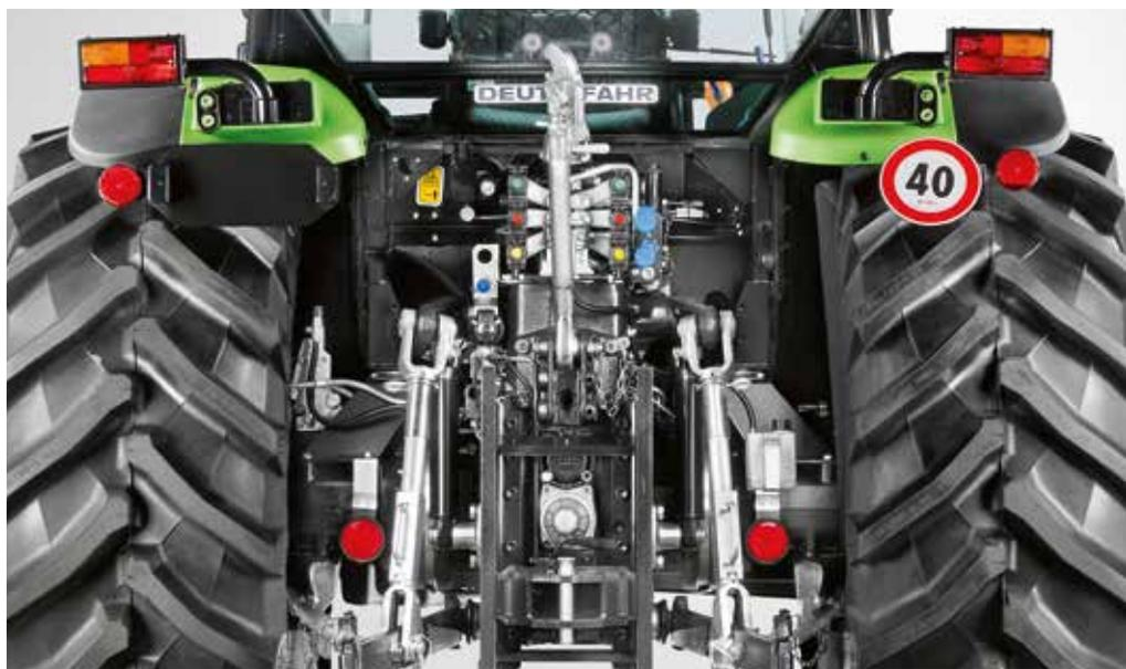
Kraftvolle Heckhydraulik: Hebt mit bis zu 5,3 t auch schwerste Anbaugeräte (6,2 t mit zusätzlichen Hubzylindern beim Modell 430)
