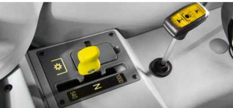
Vier Zapfwelldrehzahlen bequem in der Fahrerkabine vorwählen.
