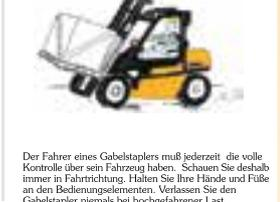
Der Fahrer eines Gabelstaplers muß jederzeit die volle Kontrolle über sein Fahrzeug haben. Schauen Sie deshalb immer in Fahrtrichtung. Halten Sie Ihre Hände und Füße an den Bedienungselementen. Verlassen Sie den Gabelstapler niemals bei hochgehoher Last.
