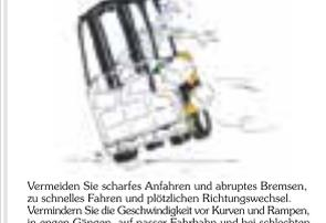
Vermeiden Sie scharfes Anfahren und abruptes Bremsen, zu schnelles Fahren und plötzlichen Richtungswechsel. Vermindern Sie die Geschwindigkeit vor Kurven und Rampen, in engen Gängen, auf rasser Fahrbahn und bei schlechten Sichtverhältnissen. Fahren Sie auch ohne Ladung vorsichtig. Bedienen Sie Ihren Gabelstapler schonend und vermeiden Sie Unfälle.
