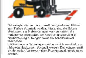
Gabelstapler dürfen nur an hierfür vorgesehenen Plätzen zum Parken abgestellt werden. Hierzu sind die Gabeln abzulassen, das Hubgerüst nach vorn zu neigen, die Parkbremse anzuziehen, der Fahrtrichtungsschalter in Neutralstellung zu bringen sowie der Schaltschlüssel abzuziehen. LPG-betriebene Gabelstapler dürfen nicht in unmittelbarer Nähe von Heizkörpern abgestellt werden. Des Weiteren muß bei ihnen das Absperrventil am Flüssiggastank geschlossen werden.
