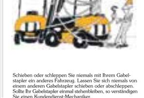
Schieben oder schleppen Sie niemals mit Ihrem Gabelstapler ein anderes Fahrzeug. Lassen Sie sich niemals von einem anderen Gabelstapler schieben oder abschleppen. Parkbremse anziehen, der Fahrtrichtungsschalter in Neutralstellung zu bringen sowie der Schaltschlüssel abzuziehen. LPG-betriebene Gabelstapler dürfen nicht in unmittelbarer Nähe von Heizkörpern abgestellt werden. Des Weiteren muß bei ihnen das Absperrventil am Flüssiggastank geschlossen werden.
