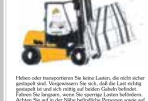
Heben oder transportieren Sie keine Lasten, die nicht sicher gestapelt sind. Vergewissern Sie sich, daß die Last richtig gestapelt ist und sich mittig auf beiden Gabeln befindet. Fahren Sie langsam, wenn Sie sperrige Lasten befördern. Achten Sie auf in der Nähe befindliche Personen sowie auf Hindernisse im Fahrgang.
