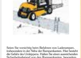
Seien Sie vorsichtig beim Befahren von Laderampen, insbesondere in der Nähe der Rampenkanten. Hier besteht die Gefahr des Umklippens. Halten Sie einen ausreichenden Sicherheitsabstand von den Rampenkanten, besonders dann, wenn der Boden naß und schlüpfrig ist.
