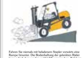
Fahren Sie niemals mit beladenem Stapler vorwärts eine Rampe hinunter. Die Bodenhaftung der gelenkten Räder kann aufgehoben werden und Unfälle verursachen. Befahren Sie mit Last Rampen vorwärts beim Hinauffahren und rückwärts beim Hinunterfahren.
