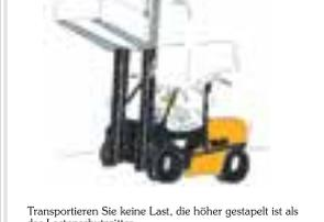
Transportieren Sie keine Last, die höher gestapelt ist als das Lasterschutzgitter. Die Last kann herunterfallen und Sie und andere in der Nähe befindliche Personen verletzen.
