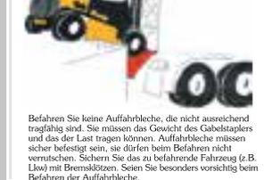
Befahren Sie keine Auffahrbleche, die nicht ausreichend tragfähig sind. Sie müssen das Gewicht des Gabelstaplers und das der Last tragen können. Auffahrbleche müssen sicher befestigt sein, sie dürfen beim Befahren nicht verrutschen. Sichern Sie das zu befahrende Fahrzeug (z.B. LKW) mit Bremsklötzen. Seien Sie besonders vorsichtig beim Befahren der Auffahrbleche.
