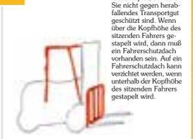
Bedienen Sie keinen Gabelstapler, bei dem Sie nicht gegen herabfallendes Transportgut geschützt sind. Wenn über die Kopfhöhe des sitzenden Fahrers gestapelt wird, dann muß ein Fahrerschutzdach vorhanden sein. Auf ein Fahrerschutzdach kann verzichtet werden, wenn unterhalb der Kopfhöhe des sitzenden Fahrers gestapelt wird.
