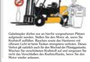
Gabelstapler dürfen nur an hierfür vorgesehenen Plätzen aufgestellt werden. Stellen Sie den Motor ab, wenn Sie Kraftstoff auffüllen. Rauchen sowie das Handieren mit offenem Licht ist beim Tanken strengstens verboten. Dieses Verbot gilt natürlich auch für den Wechsel der Flüssiggastanks. Wischen Sie verschütteten Kraftstoff auf und vergessen Sie nicht das Verschließen des Kraftstofftanks, bevor Sie den Motor wieder anlassen.
