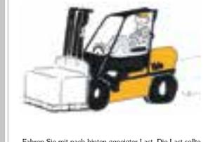
Fahren Sie mit nach hinten geneigter Last. Die Last sollte möglichst in Bodennähe gehalten werden. Dadurch erhält Ihr Gabelstapler eine höhere Stabilität und die Sichtverhältnisse werden besser.
